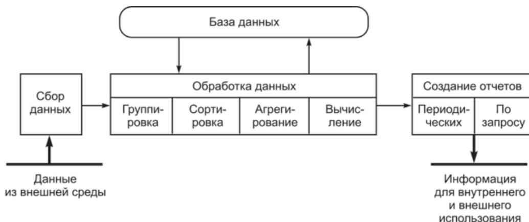
Рис.1. Схема работы информационной системы
