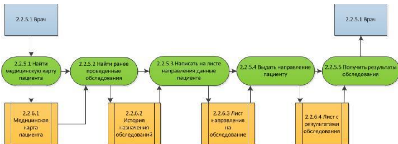
Рис. 2.4. Процесс «Назначить обследование» на 3-м уровне модели As-Is в нотации DFD
