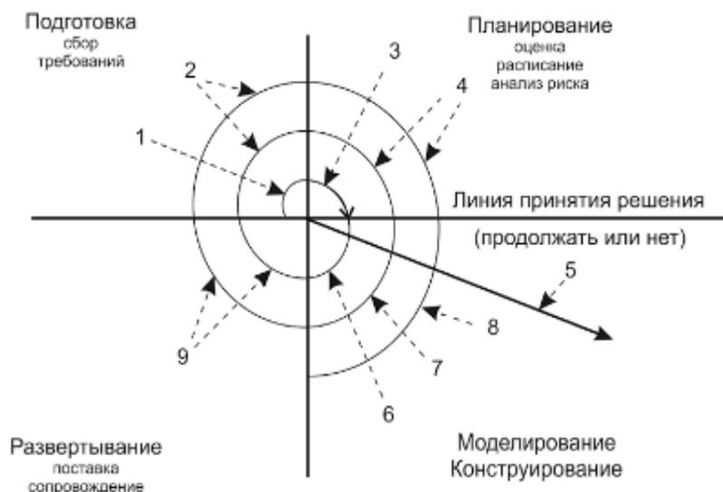
**Рис. 1.1.** Спиралевидная модель: 1 - начальный сбор требований проекта; 2 - та же работа, но на основе рекомендаций заказчика; 3 - планирование проекта и анализ риска с использованием начальных требований; 4 - планирование и анализ рисков; 5 - переход к комплексной системе; 6 - начальный макет системы; 7 - версия системы следующего уровня; 8 - разработанная система; 9 - оценивание заказчиком
